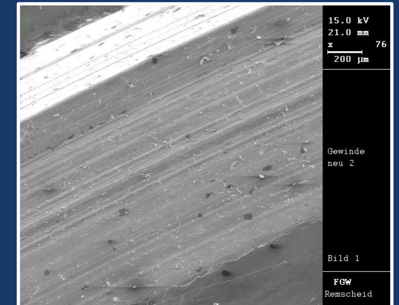
Gewinde-Oberfläche REM-Mikroskopie (22° Winkel) /Neue SCHUMACHER-Geometrie
